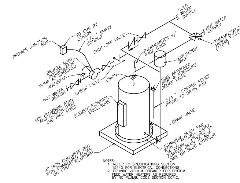
ELECTRIC WATER HEATER-RECIRCULATING TYPE
