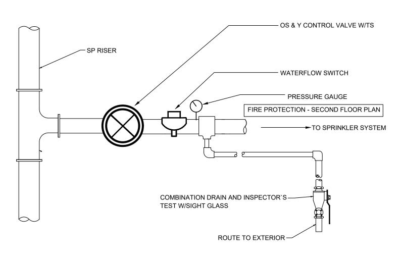
TYPICAL SPRINKLER CONTROL VALVE ASSEMBLY 4
